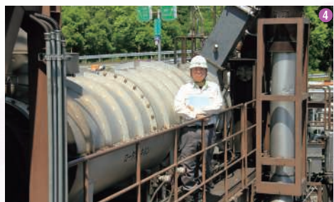
①敷地内にはチップ化された原料が山積みになっている ②チップ化されたバイオマス原料 ③同時稼働できる発電機は3機（計150kw）。現在、まだ全稼働はしていない ④高温でガスを抽出する熱分解炉（ロータリーキルン）
